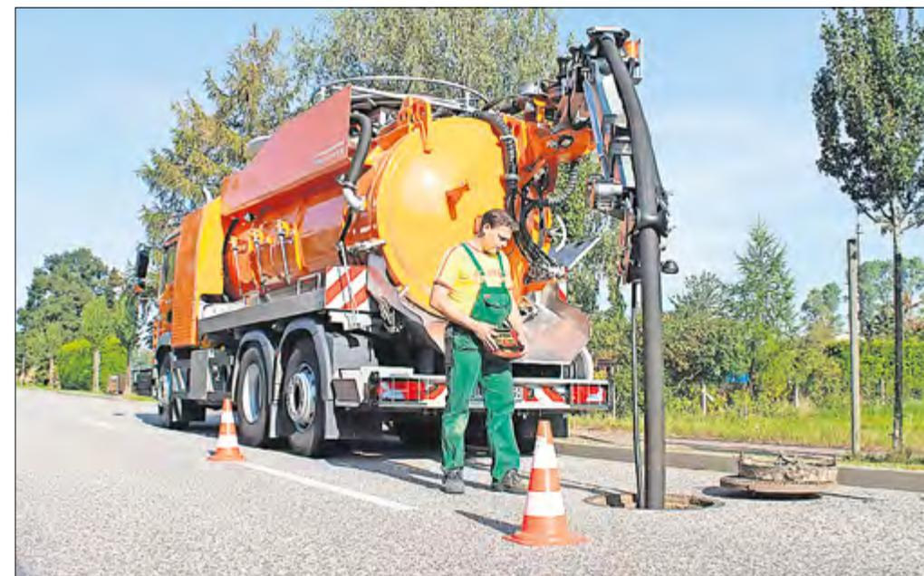
Der 120 Meter lange Spülschlauch als auch der 20 Meter lange Saugschlauch tauchen per Fernsteuerung mit ein paar Bewegungen der Fingerspitzen in den Untergrund ab.
